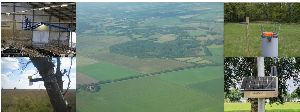
Figuur 1 Liefstingsbroek (midden) en foto's van een aantal van de gebruikte meetopstellingen (van linksboven gezien met de klok mee: meetleiding in de stal, bulkdepositie met Alpha sampler, NitroSense sensorbox en Gradko passieve sampler).
