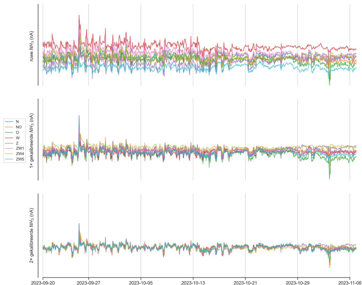
Figuur 26 Ruwe \text{NH}_3 data tijdens de tweede colocatieperiode, waarin alle sensoren op dezelfde plek hingen, na een jaar lang te hebben gemeten. Het bovenste paneel laat de ruwe data zien. Het middelste paneel laat dezelfde data zien waarbij alleen is gekalibreerd op basis van de eerste colocatieperiode. Het onderste paneel laat dezelfde data zien waarbij zowel de eerste als de tweede colocatieperiode is gebruikt voor de kalibratie.
