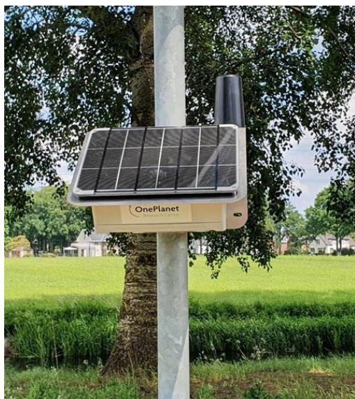
Figuur 8 Vooraanzicht en onderaanzicht van de NitroSense van OnePlanet Research Center. Op het vooraanzicht zijn het zonnepaneel en de antenne zichtbaar. Op het onderaanzicht zijn de openingen van de drie sensoren zichtbaar, v.l.n.r.: \text{NO}_2 , \text{NH}_3 , temperatuur/luchtvochtigheid.
